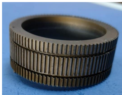
Figura 7.2 Stânga – coroana rotorului cu 90 de dinți. Dreapta – ansamblu coroane rotorice-magneți permanenți.
