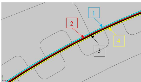
Figura 6.1 Împărțirea întrefierului în benzi de volume egale.
